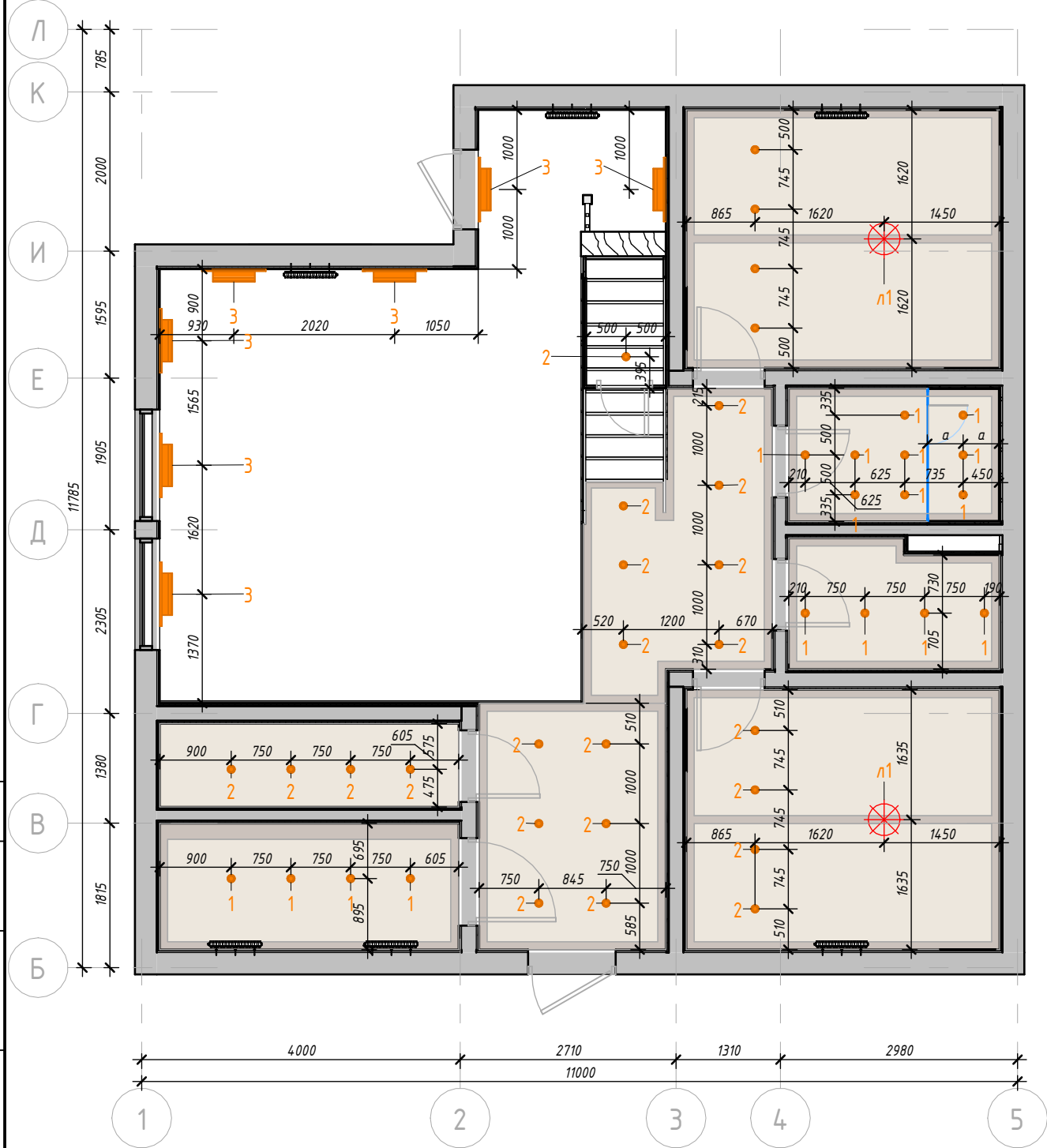
Уровень 1 (План потолка с привязкой осветительного оборудования) (1 : 75)
